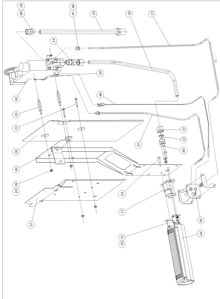
Монтированная труба горения GF 35.11 и GF 35.1 (1991)
