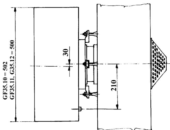
Рис. 3. Монтаж установки с закрытой камерой сгорания
