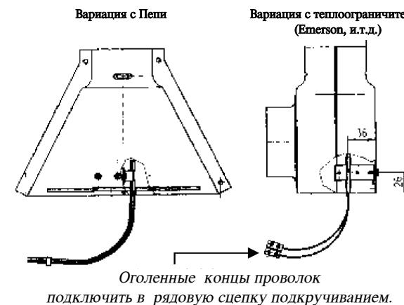
Рис 2. Подключение теплоограничителя.
