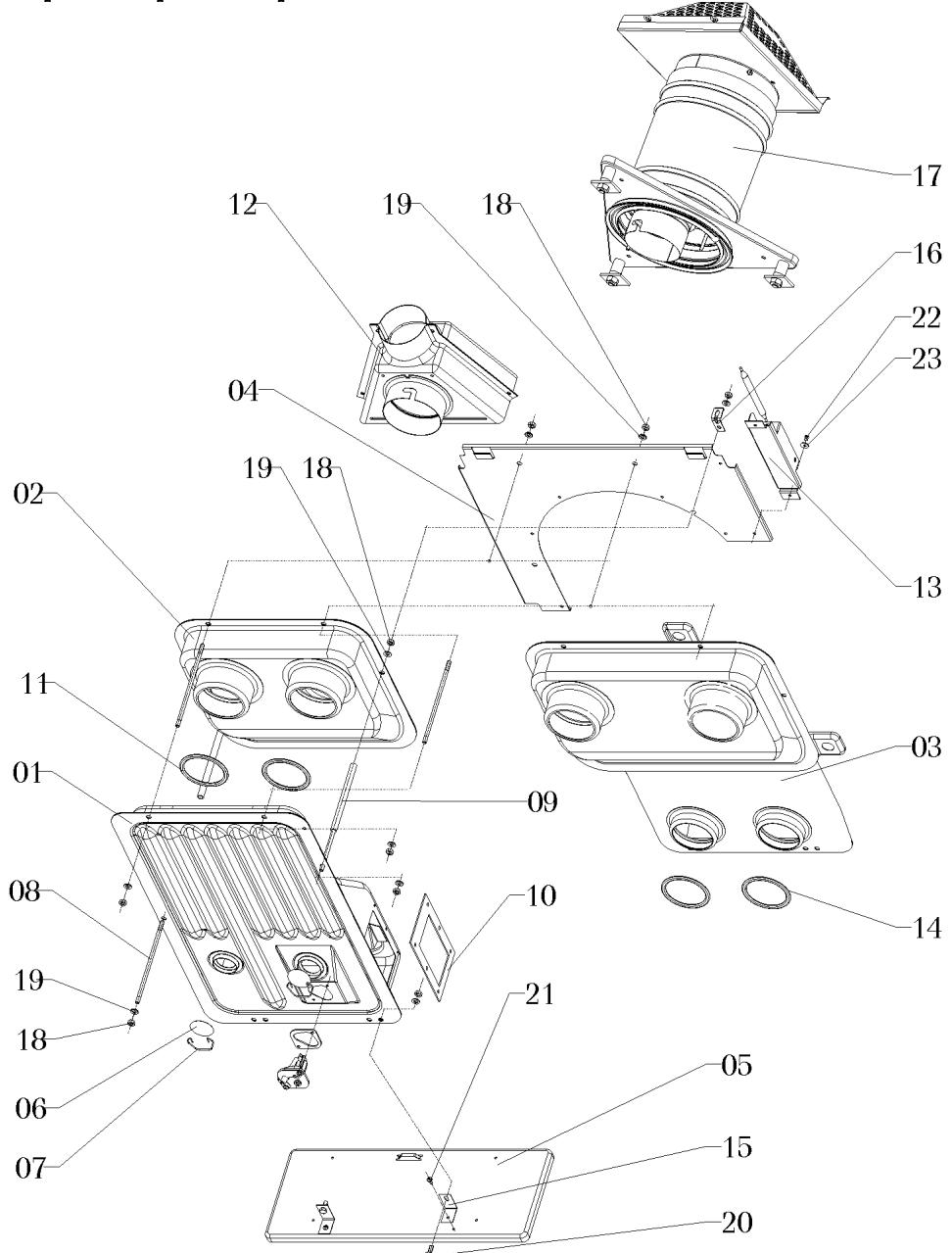
Рис. 8. Взорванный чертеж монтированного теплоиспользователя
